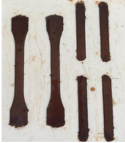
Şekil 2. Zeytin Çekirdeği Dolgulu Numunelerin Kalıptaki Görüntüsü
