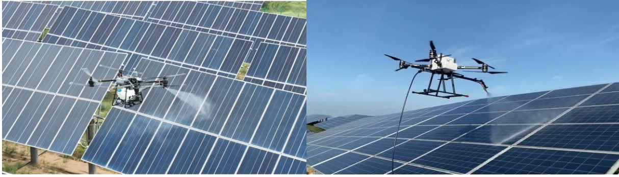
Görsel 6. Fotovoltaik (PV) Tesisler İçin Dron İle Temizleme Sistemi
